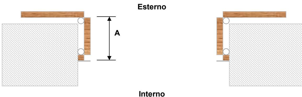
**(A)** = Misura standard prima anta compreso telaio: 120 / 160 / 195 / 270 mm.
