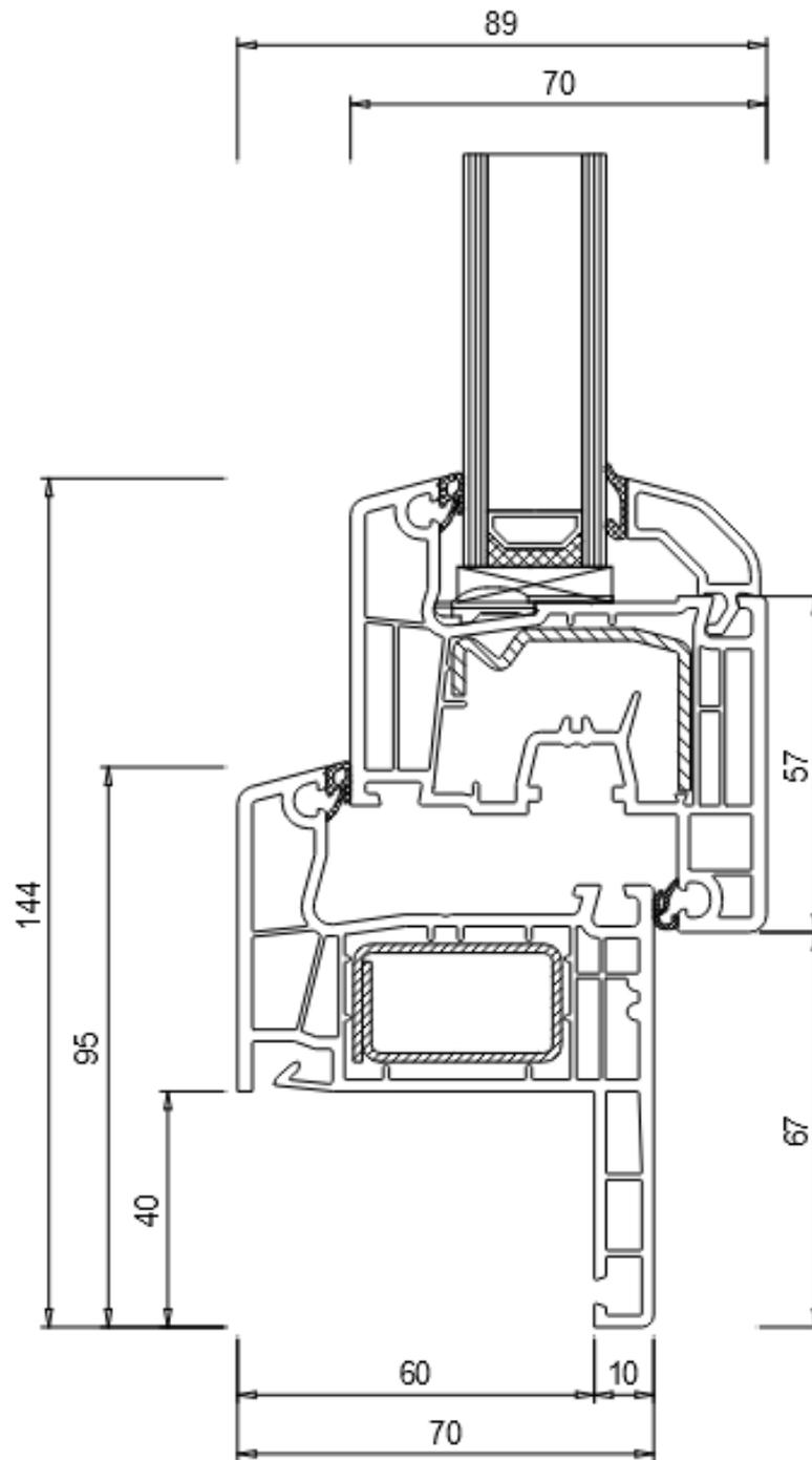
**Sezione telaio aletta 65 mm.**
