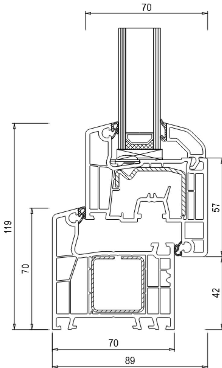
**Sezione telaio aletta 40 mm.**
