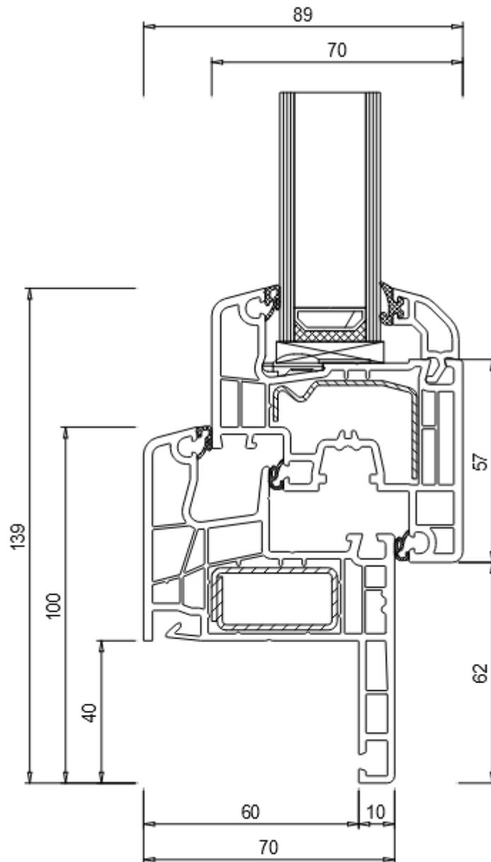
**Sezione telaio aletta 65 mm.**
