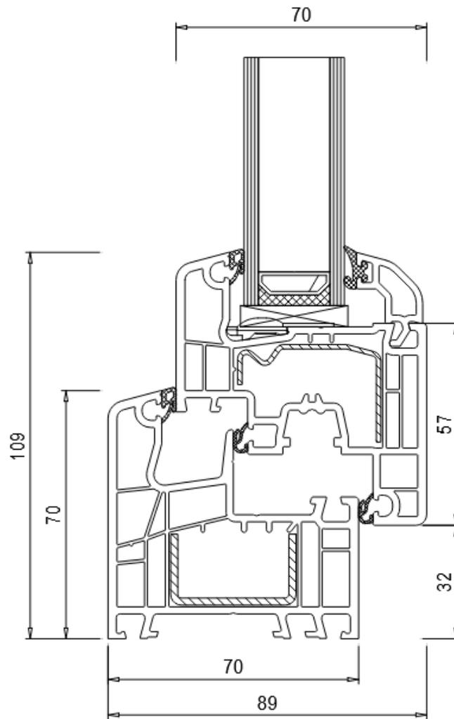
**Sezione telaio aletta 40 mm.**
