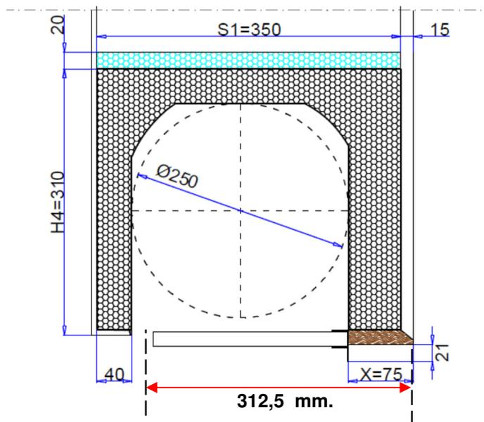
Controtelaio legno alluminio per avvolgibile, completo di guide in alluminio, predisposto per zanzariera scomparsa.
